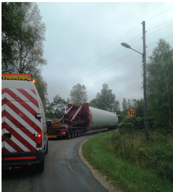
Bild på transport av torndel till ett vindkraftverk
